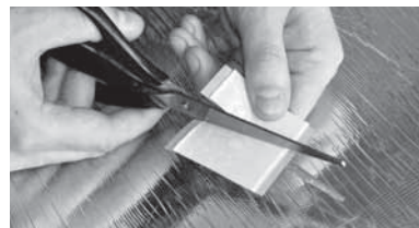
Рис. 6. Разрезание битумной изоляции на 2 части
